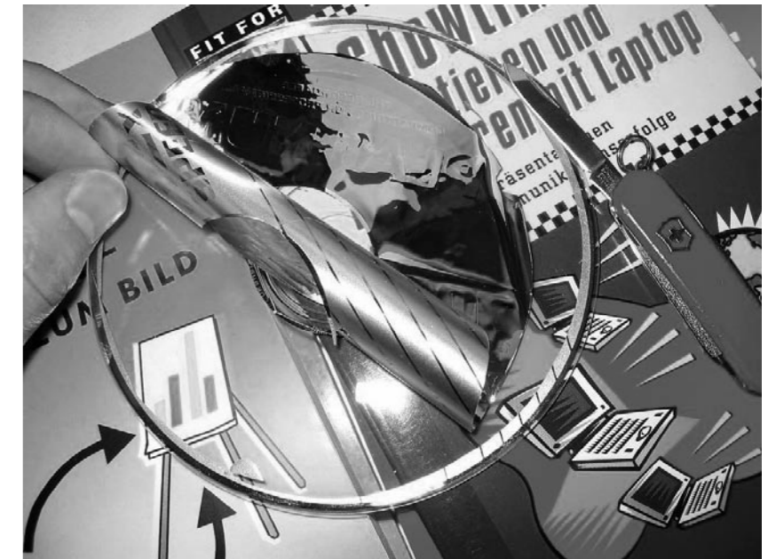
■ So sieht es aus, wenn die Datenschicht vom Rohling abgelöst wird. Der transparente Polycarbonat-Rohling wird von unten vom Laserstrahl durchleuchtet, der in der Datenschicht die Pits und Lands unterscheidet/liest. Foto: Michael Gasperl
